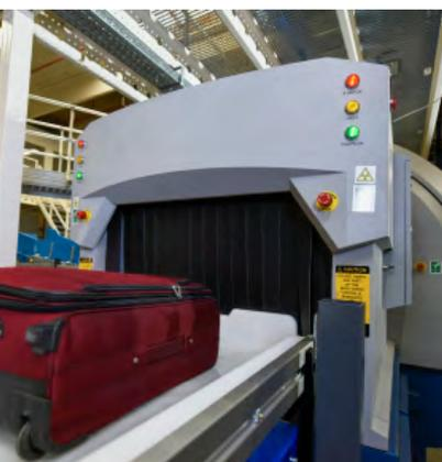
我们目前在全世界已售出 2,000 余台 CTX 爆炸物探测系统 (EDS) 装置，在提供安全解决方案上有着丰富经验和较高信誉。我们的 CTX 9800 DSi 采用可伸缩平台，达到 ECAC 第 3 号标准要求，并通过 TSA 认证。在行李检查方面，该设备具有检测水平高，误报警率低 (FAR) 的特点。计算机断层扫描 (CT) 系统具有高超的 3D 成像能力，可快速精确地检测出危险物所在。为了使设备能够与任何行李处理系统 (BHS) 联用，我们提供了多种联网解决方案，可将多台设备互相连接，实现有效监测和控制。
